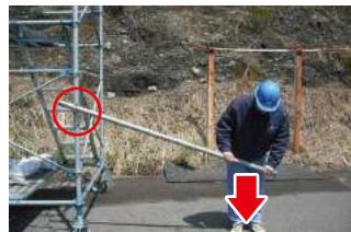
③ 直交リベットが破断し始める。
