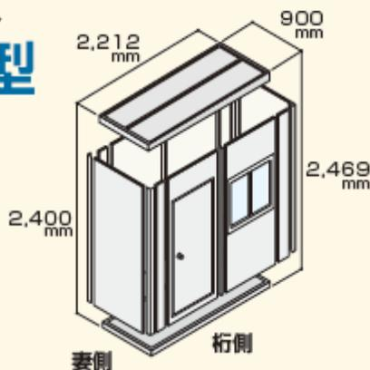
W900mm×D2,180mmの単棟基本ハウスをベースに妻桁連棟が可能です。設置場所や用途に合わせて搬入しやすいノックダウン方式です。
