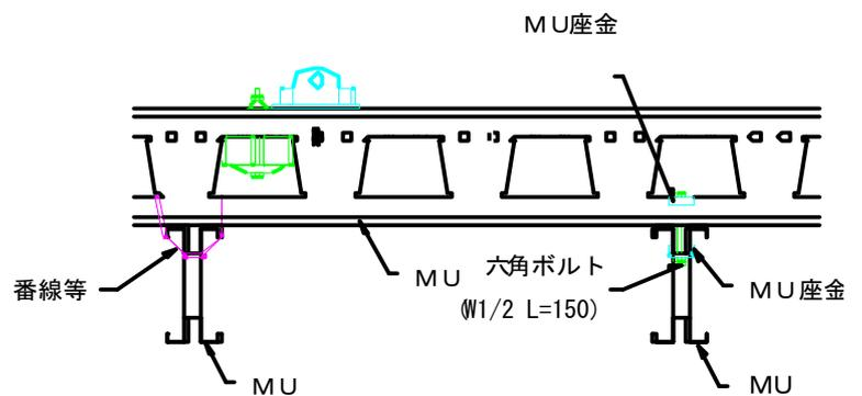
⑦コンクリート打設前に、開き止めセパレートの取付け、単管・チェーン補強を行う。
