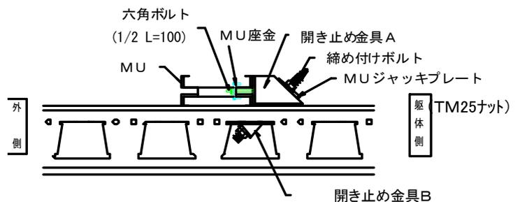
④上段で使用するMU本体に、ヒンジ金物Bを取り付ける。
