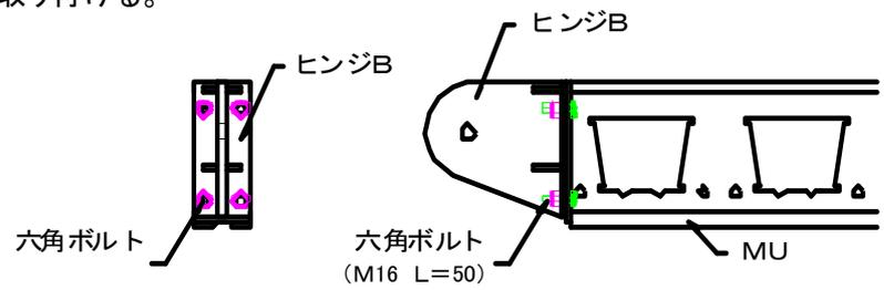
⑤上段、下段を取り付け、サポ-トを単管で補強する。
