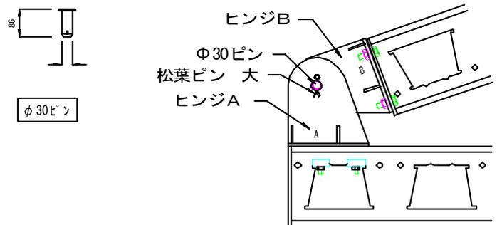
⑥レッカーで吊り上げ、土台部に設置する。
