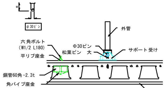
③サポート受けに、外管とジャッキ、開き止め用MU本体、を取り付ける。
