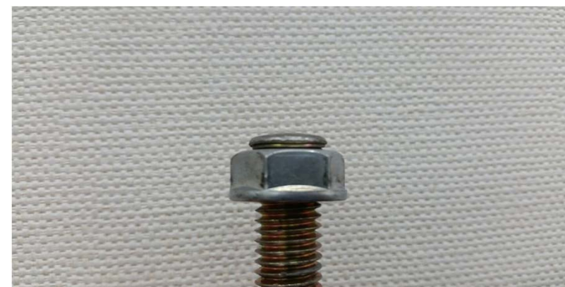
(緩め過ぎてカシメに食い込んだ状態)
